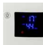
LCD-zaslon z indikatorjem relativne vlažnosti in temperature okolice.
